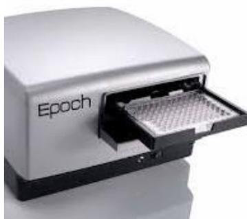
Figura 40. Lector de placas de ELISA utilizado en las técnicas ABTS, DPPH y  $\text{OH}^{\bullet}$
