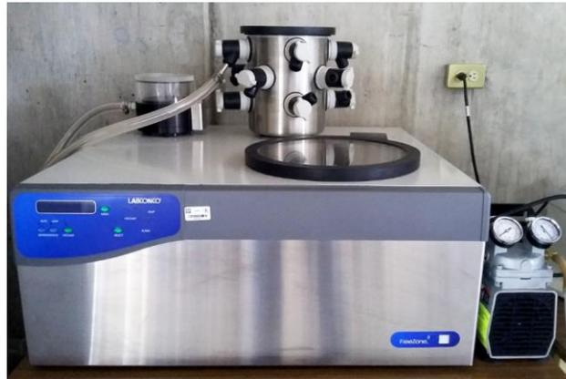
Figura 34. Liofilizador de laboratorio Labconco Mod. FreeZone 6
