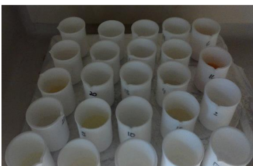
Figura 21. Disoluciones muestra, en vasos de teflón sobre una estufa de calentamiento.
