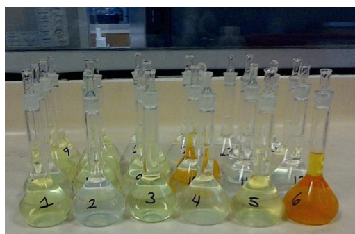
Figura 22. Diluciones de las muestras problema, con una disolución de HNO 3 al 2% (v/v)
