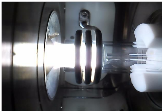
Figura 47. Antorcha generada dentro del Equipo Thermo Scientific ICAP Q (Hernández et al. 2004).
