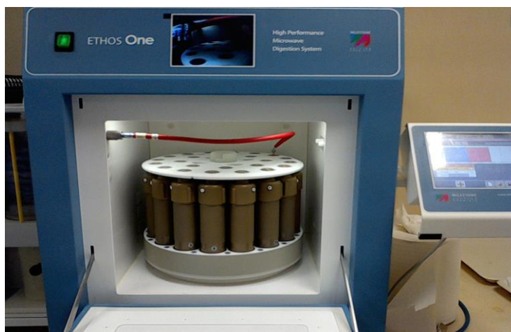
Figura 20. Tubos de teflón colocados en un horno de microondas de digestión
