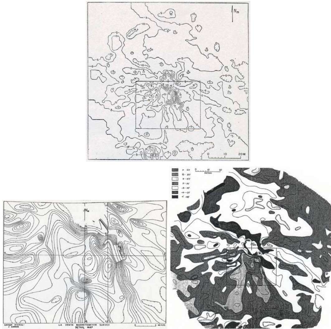
Figs. IV.66 a) Mapa magnetométrico de gran pirámide; b) detalle y c) curvas de nivel sombreadas y coloreadas (a) Morrison, Benavente, Clewlow y Heizer, 1969:29, Fig. 5; Morrison, Clewlow y Heizer, 1970 a :1489, Fig. 2; b) Morrison, Benavente, Clewlow y Heizer, 1969: 30, Fig. 6; Morrison, Clewlow y Heizer, 1970 b , Fig. 5; c) Morrison, Clewlow y Heizer, 1970 b , Fig. 6).
