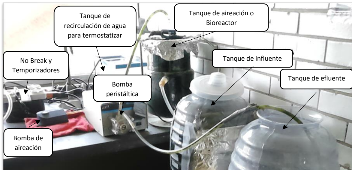
Figura 11. Reactor de lodos activados tipo SBR a escala laboratorio
