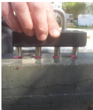
Figura 54 Método de las cuatro puntas para medir la resistividad del hormigón
