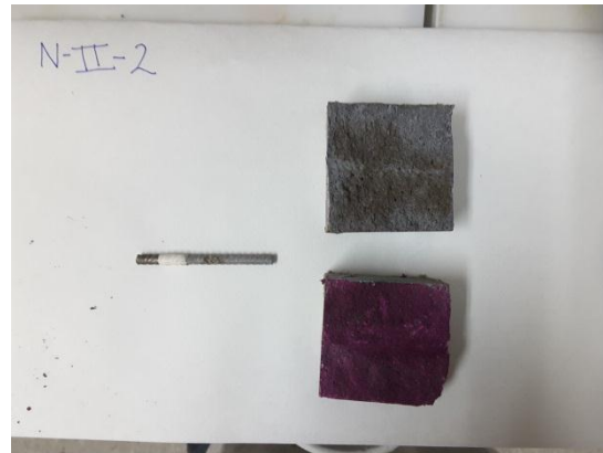
Figura 48 Aplicación de fenolftaleína para prueba de carbonatación
