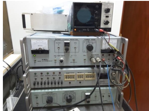
Figura 29. Equipo para medir Ecorr
