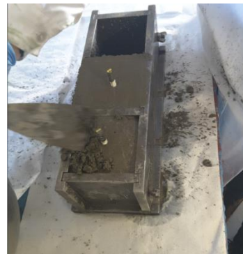
Figura 12 Vertido de mezcla en moldes
