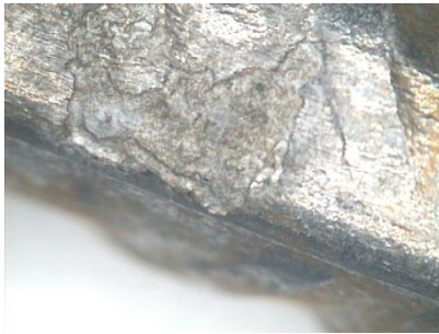
Figura 47 Pérdida de material en barra de la probeta E-III-1
