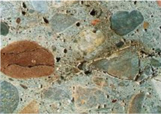
Figura 5 Acetato de uranilo en una reacción álcali sílice
