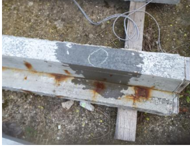
Figura 51 Se humedecen los puntos donde se hicieron las medidas
