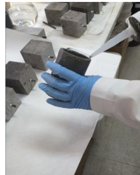
Figura 16. Cordón de silicona en el tubo
