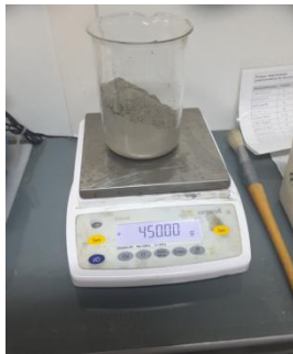
Figura 7. Peso de cemento
