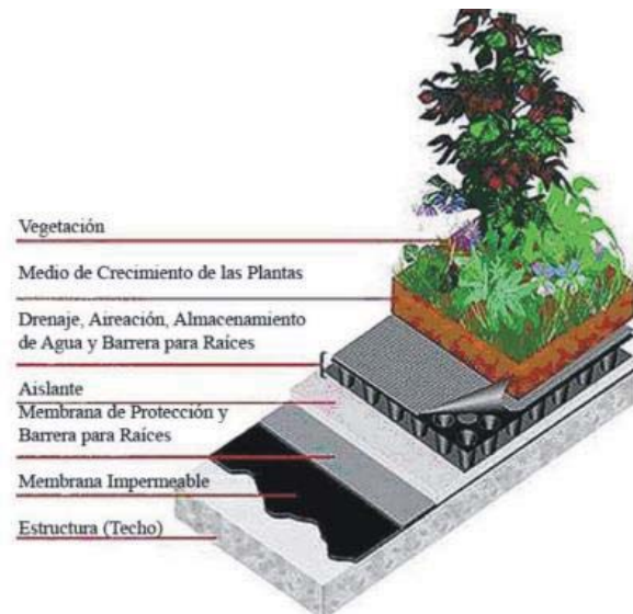
Fig. 1.28 Corte de cubierta verde.
