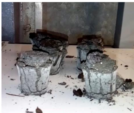
Figura 5.9 Probetas que no fraguaron elaboradas con CAC.
