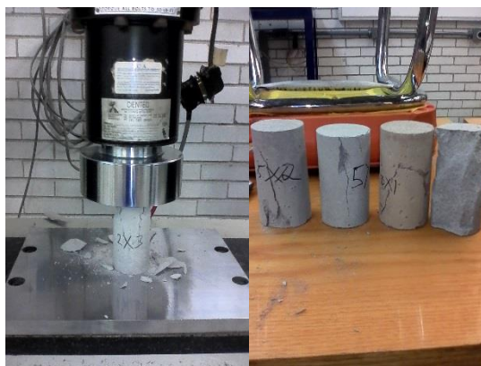
Figura 5.15 A) Puesta del monolito bajo el cabezal de la máquina, B) Falla y ruptura de los monolitos.
