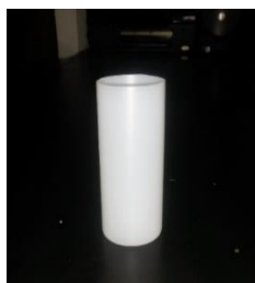
Figura 5.7 Molde para monolitos cilíndricos.
