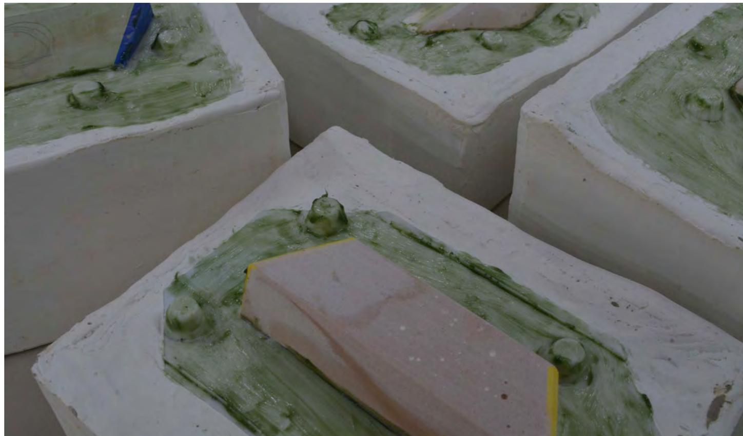
Posteriormente se realizaron modelos a escala hechos con moldes de silicón y vaciados en cemento para poder jugar con las diferentes configuraciones posibles.
