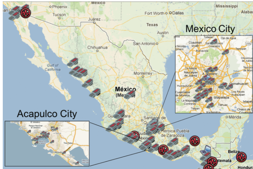
Figura 11. Distribución de sensores en México de la RAS(abril de 2013). Los iconos de USB indican los sensores externos, los iconos portátiles los sensores internos y los círculos corresponden a terremotos M > 3.5 según lo informado por el Servicio Geológico de Estados Unidos (USGS) (Domínguez, L. A. et al., 2015).
