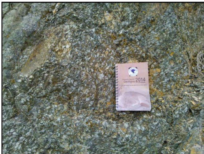
Figura 22. Fenocristales de plagioclasa de grano grueso de entre 1 y 2 cm visibles en la Andesita Cinco Minas
