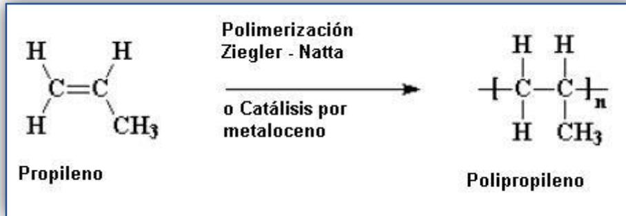
Figura 2.3 Reacción del polipropileno.
