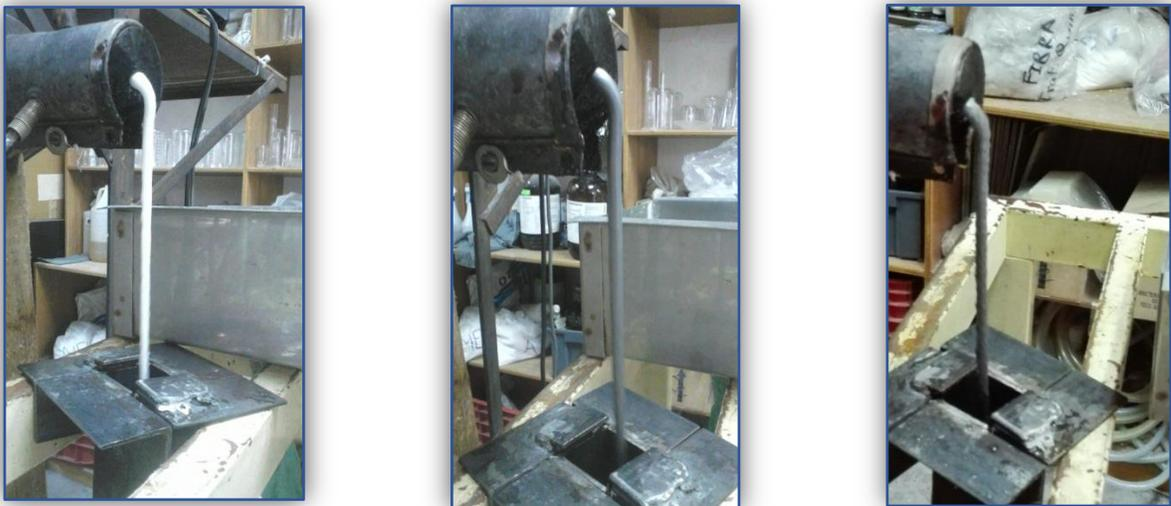
*Figura 3.3 Extrusión de PP espumado con A-L-lisina, Grafito y NTC (de izquierda a derecha).*
