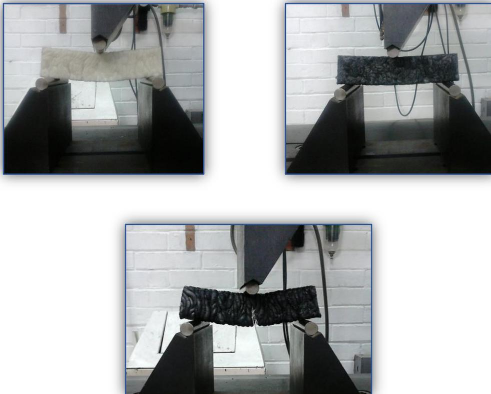
Figura 3.4 Pruebas de Flexión al PP espumado con A-L-lisina, Grafito y NTC (de izquierda a derecha).
