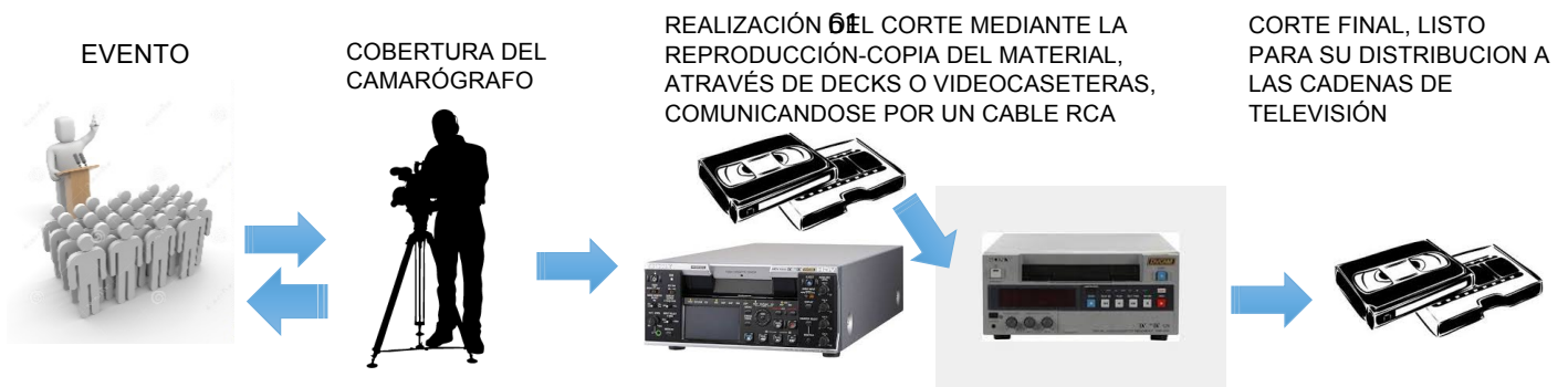
Figura 3.4 Proceso analógico para la realización del corte de televisión en la Coordinación General de Comunicación Social, por el sistema “ Corte Directo. ”
