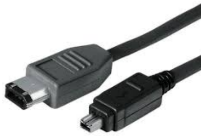
Figura 3.7 Cable Firewire de entradas de 4 a 6 pines. Ofrecía una velocidad de transferencia de 400 Mb / s. Estos cables podían de ser de 4 a 4 pines o 6 a 6 pines, dependiendo de las entradas de los dispositivos. Posteriormente Apple creo una entrada Firewire que necesitaba un cable de 4 a 9 pines, cuya tasa de transferencia era de 800 Mb / s.
