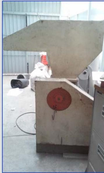
*Figura 3.4 Molino de cuchillas de alta velocidad.*
