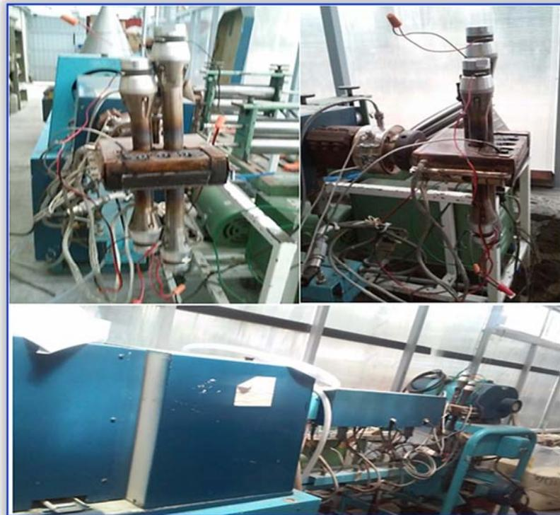
*Figura 3.3 Extrusor mono husillo y piezoeléctricos.*
