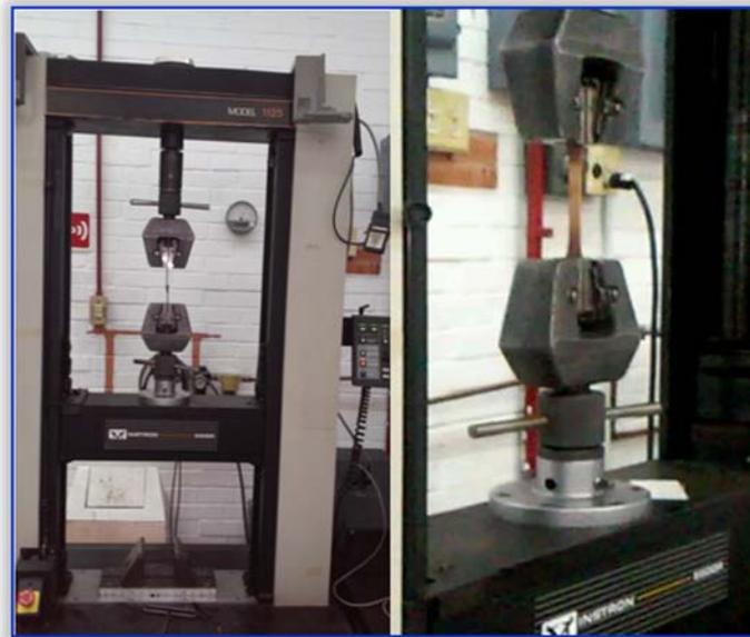
*Figura 3.5 Máquina de pruebas universales INSTRON.*
