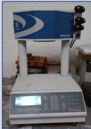
Figura 2.55 Medidor del índice de fluidez.
