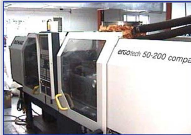
*Figura 3.2 Máquina de moldeo por inyección*
