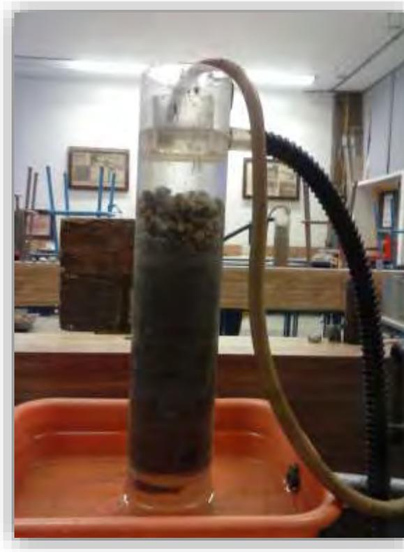
Ilustración 19. Prueba de permeabilidad a carga constante.
