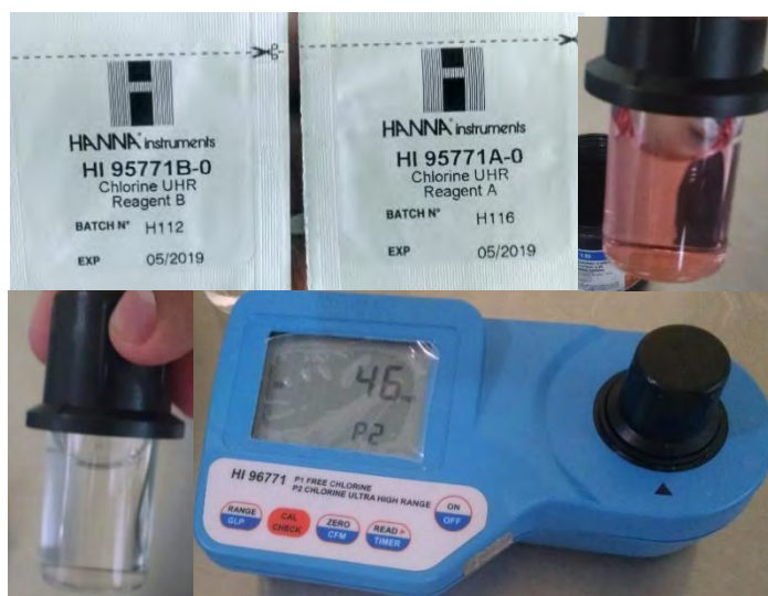
Figura 16. Verificación de las propiedades de la SES: a) Medición de pH y ORP, b) Medición de cloro libre o cloro de ultra alto rango (UHR, por sus siglas en inglés) por espectrofotometría.
