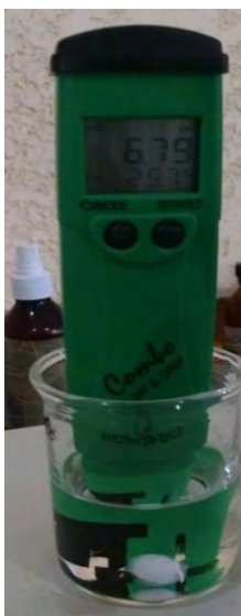
Figura 16. Verificación de las propiedades de la SES: a) Medición de pH y ORP, b) Medición de cloro libre o cloro de ultra alto rango (UHR, por sus siglas en inglés) por espectrofotometría.
