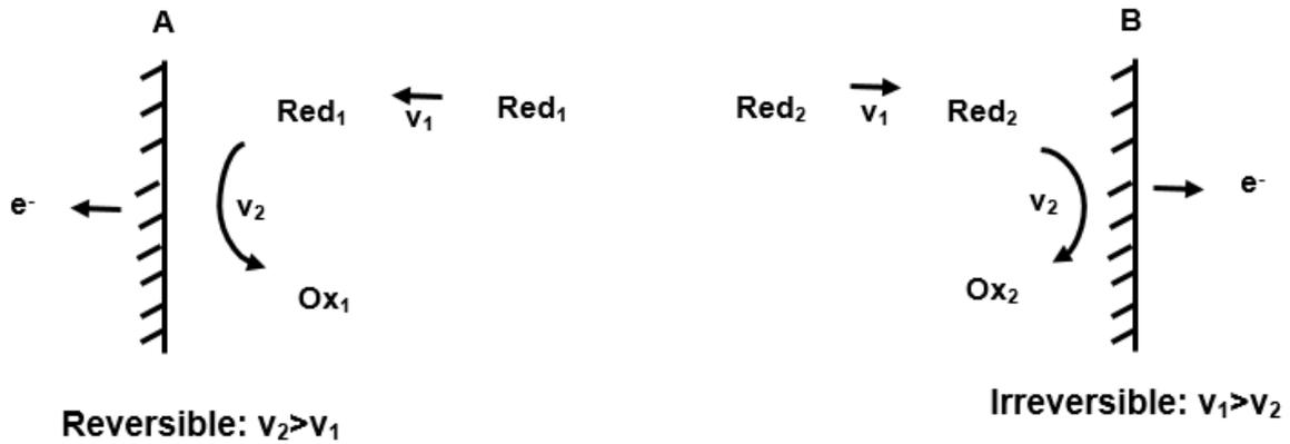
Fig. 11 Representación esquemática de A: proceso reversible y B: proceso irreversible al electrodo.
