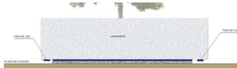
ESQUEMA DE COLOCACIÓN DE TIRAS DE LED EN JARDINERAS
