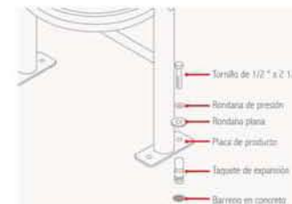
DETALLE ANCLAJE DE BOTE DE BASURA A PISO
