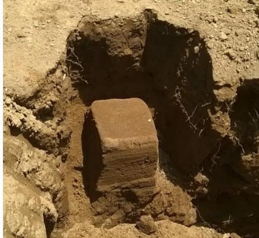
*Figura III.1 Muestra cubica labrada.*
