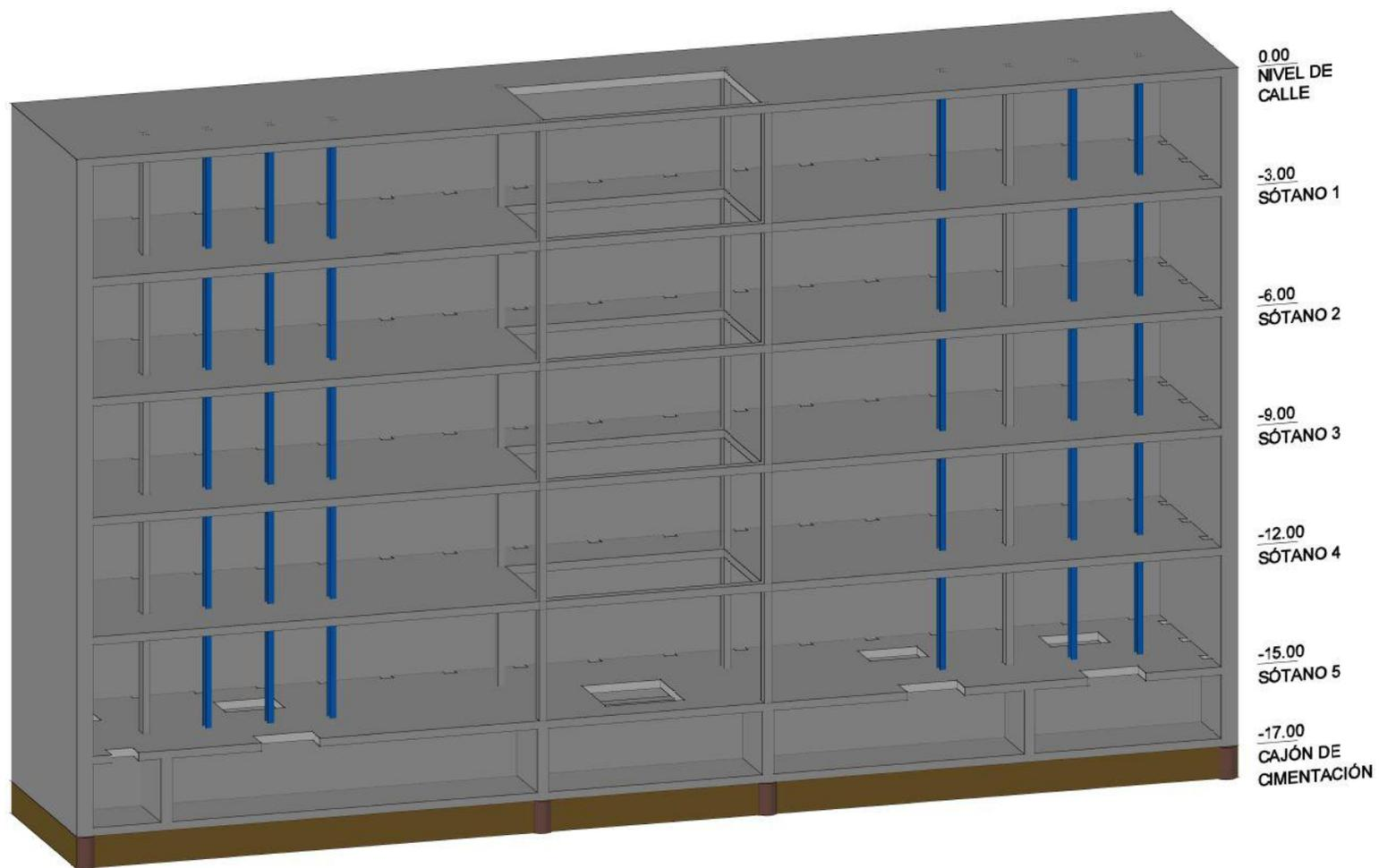
Figura A.41 Corte eje D. Etapa 7. Fin de la etapa y de todos los niveles de la sub-estructura..
