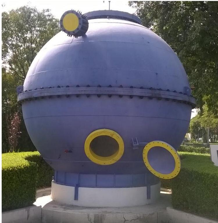
*Figura IV.4 Cámara triaxial diseñada por Raúl J. Marsal.*
