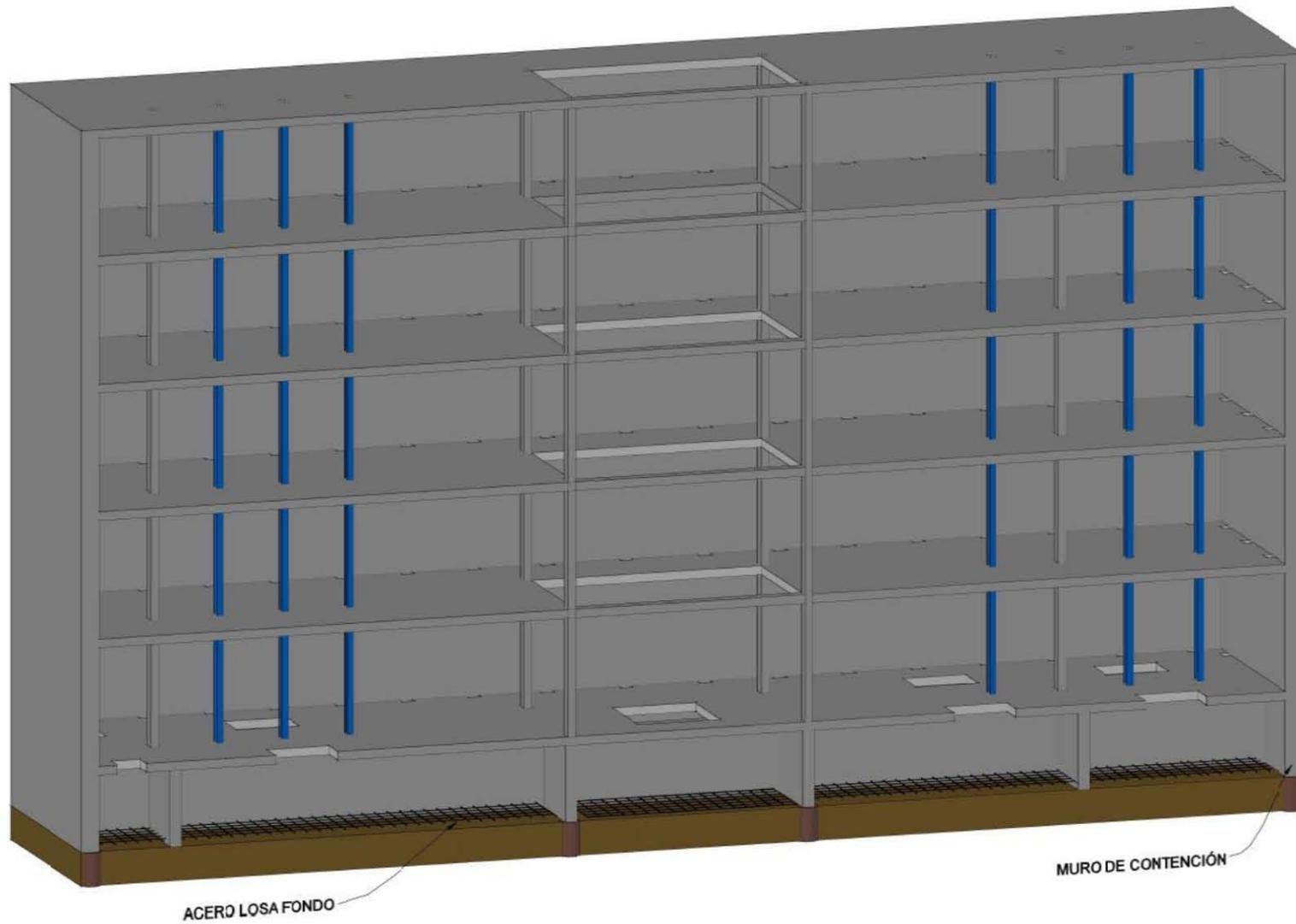
Figura A.40 Corte eje D. Etapa 7. Preparación para el colado de la losa de fondo. Colocado de acero de refuerzo.
