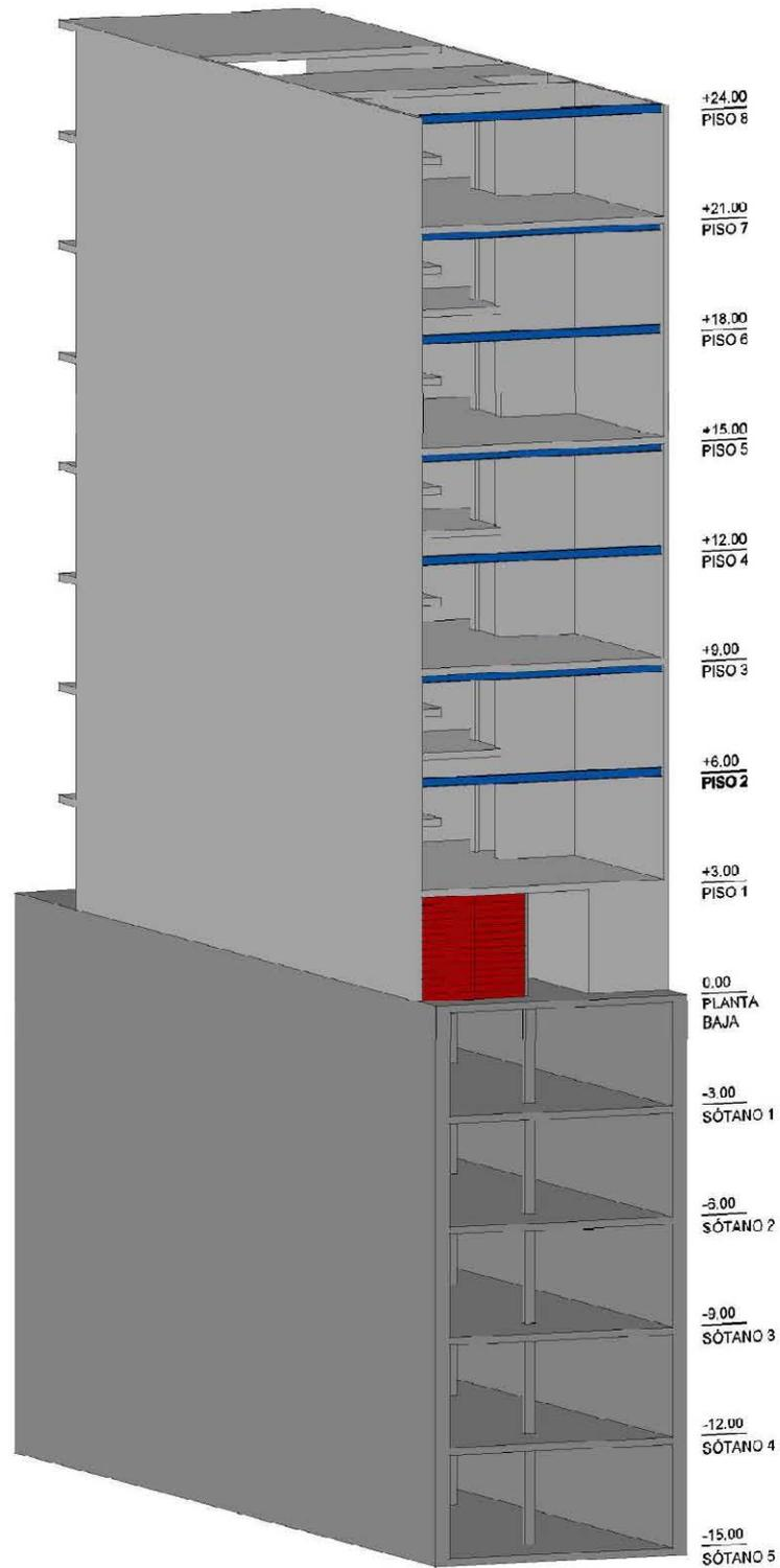
Figura A.35 Corte eje 4. Avance de la súper-estructura, respecto a la construcción de los sótanos.
