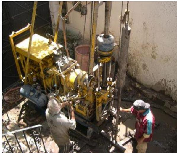
*Figura III.5 Prueba de Penetración Estándar.*
