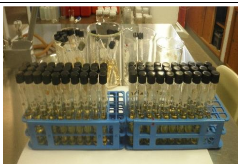
Fig. 4. a) Medio de cultivo lactosado para determinar el número más probable de bacterias coliformes totales y fecales.
