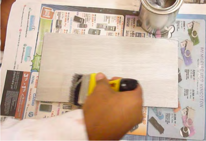
Fig.-31 Aplicación de arriba hacia abajo y de abajo hacia arriba
