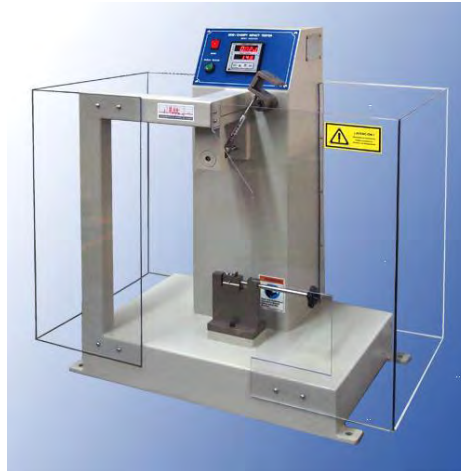
Fig.15.- Máquina de ensayo de impacto (Izod)
