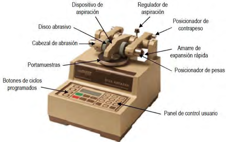
Fig.11.-Máquina para pruebas de abrasión http://tecnologiadelosplasticos.blogspot.mx/2011/06/propiedades-mecanicas.html (2013)
