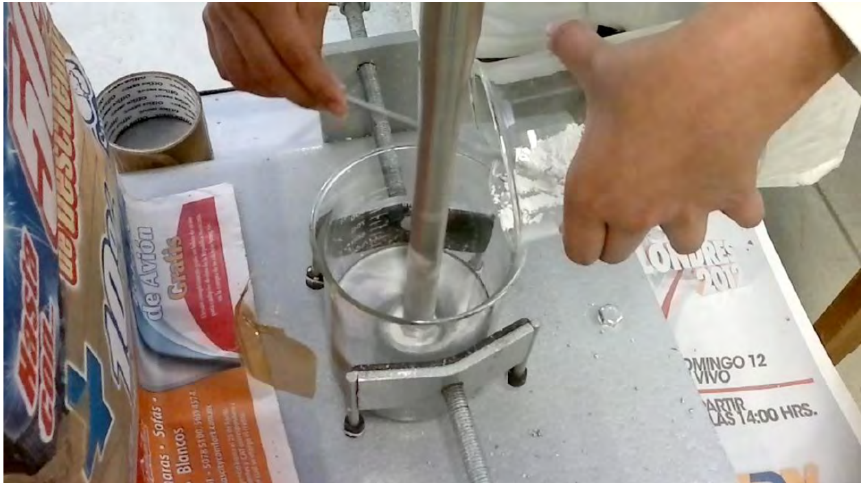
Fig.-23 Mezcla de Espesante celulósico y carbonato de calcio. Laboratorio de Ingeniería Química facultad de Química CU, UNAM.
