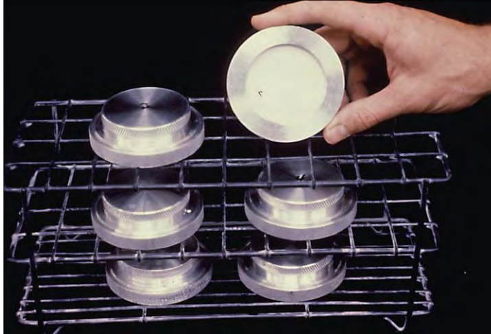
Fig.21.-Prueba de humedad.
