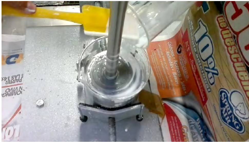
Fig.-24 Mezcla de Resina Acrílica Elastomérica. Laboratorio de Ingeniería Química facultad de Química CU, UNAM.
