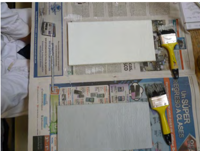
Fig.-33 Aplicación de impermeabilizante.
