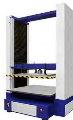
http://tecnologiadelosplasticos.blogspot.mx/2011/06/propiedades-mecanicas.html (2013) Fig.12.- Máquinas para diferentes pruebas de compresión
