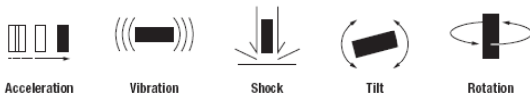
Figura 12. Tipos de mediciones por MEMS (Analog Devices, Inc, 2014a).
