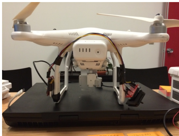
Figura 29. Montado de placa IMU (izquierda) y radio (derecha) sobre el dron.
