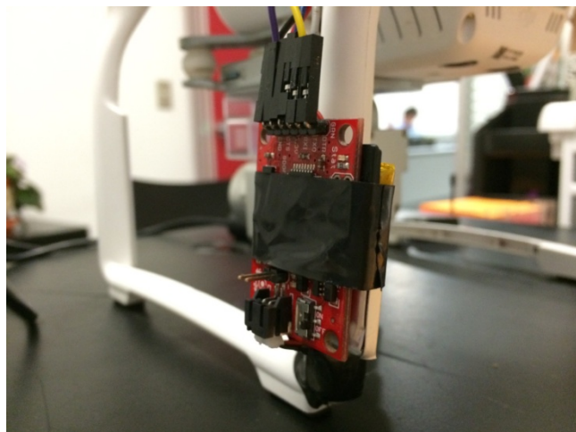
Figura 7. Placa montada sobre la extremidad inferior del dron.
