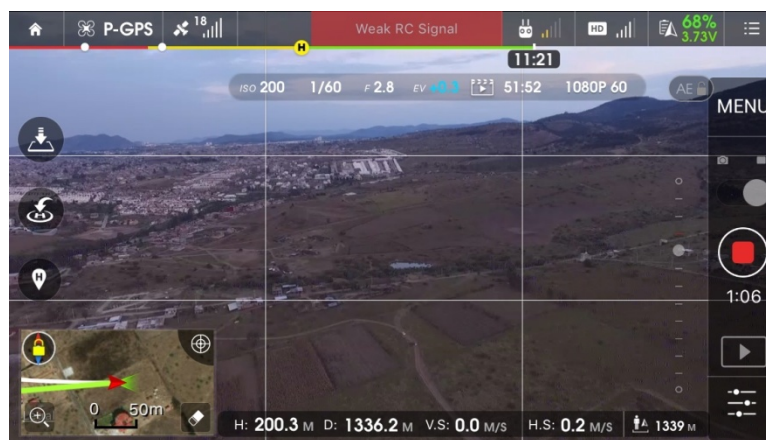
Figura 30. Impresión de pantalla de un teléfono inteligente utilizado para monitorear el vuelo y recorrido del dron en tiempo real. En la parte inferior se aprecian los valores H: 200.3 y D: 1336.2 que corresponden a la altura y distancia a la cual todavía se registraron datos correctos de la placa IMU.
