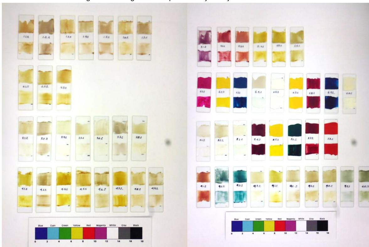
Figura 106. Fotografía de las probetas almacenadas por dos meses en atmósfera de ácido acético.
