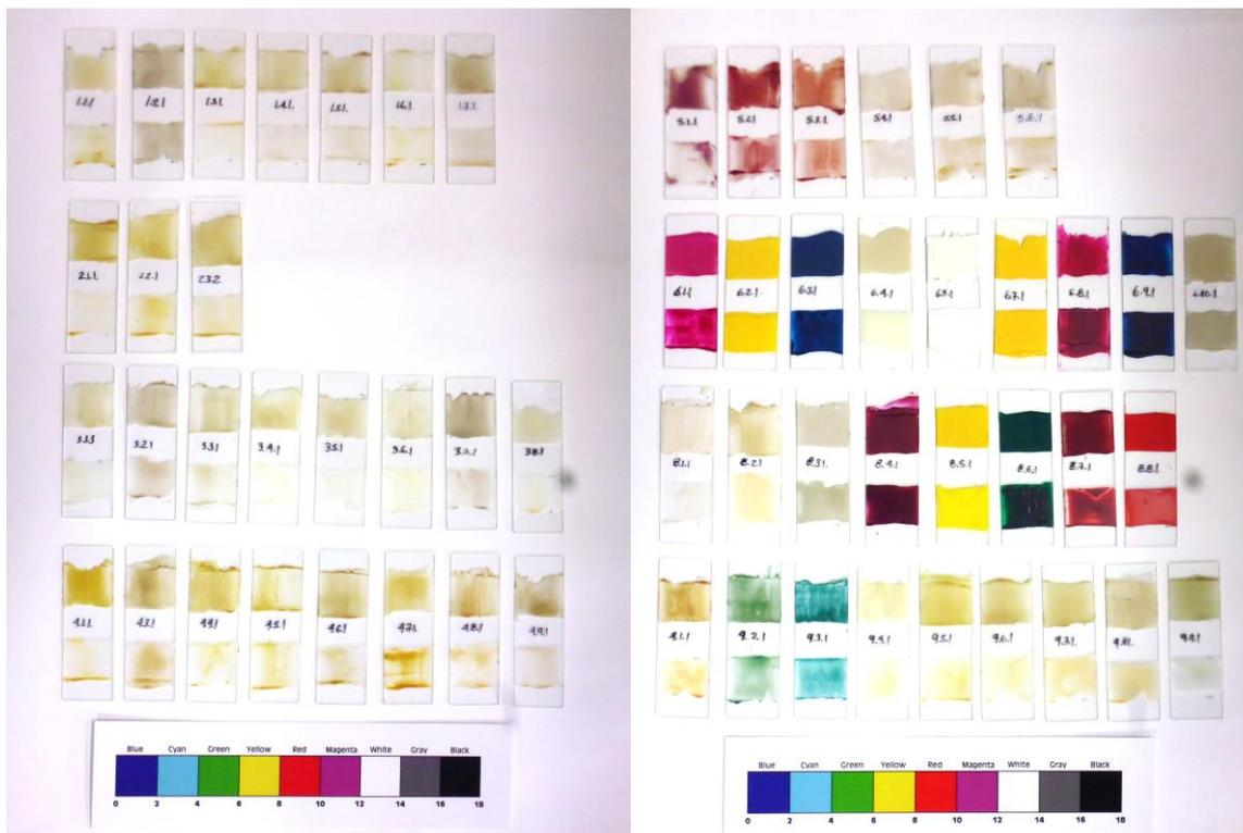
Figura 105. Fotografía de las probetas bajo envejecimiento acelerado.
