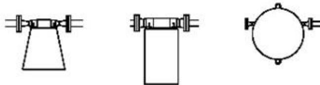
b) Orientaciones para gases (autodrenante): tubos hacia arriba, tubería horizontal.
