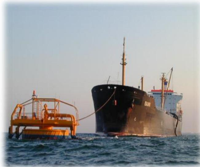
*Figura 5. Descarga de combustóleo transportado por vía buque-tanque a través de monoboyas. Fuente: CFE, Gerencia de Combustibles Líquidos.*
