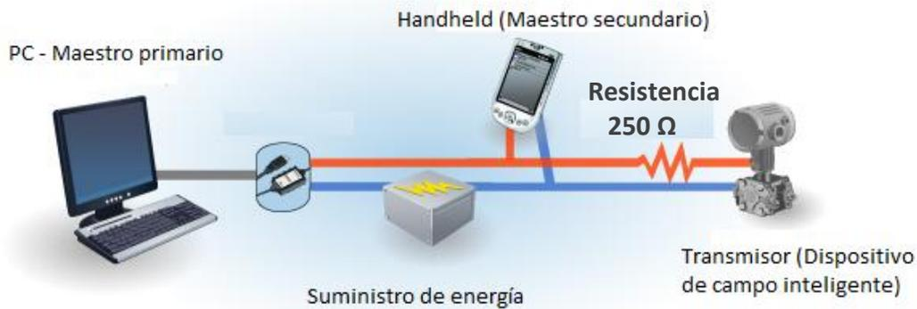
Figura 85. Protocolo HART que permite la comunicación con un instrumento de campo sobre un lazo de corriente de 4-20 mA.
