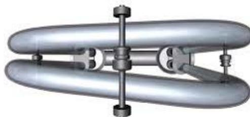
Figura 48. Efecto coriolis producido en los tubos del sensor del medidor. (Micro Motion, 2015).
