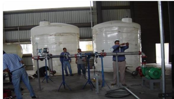
*Figura 82. Patín móvil y patín fijo empleados para la calibración de medidores de flujo tipo coriolis de la CFE.*
