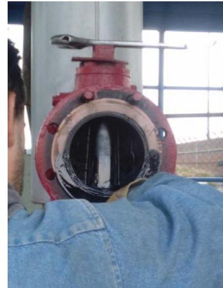
*Figura 99. Deposición de asfaltenos en tuberías y válvulas.*
