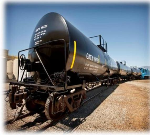
Figura 6. Carro-tanque empleado para el transporte de combustibles líquidos. Fuente: CFE, Gerencia de Combustibles Líquidos.
