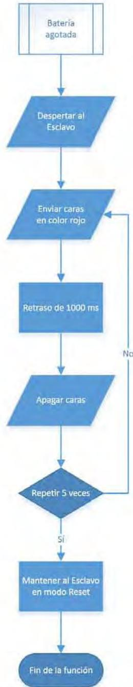
Figura 3.87: Diagrama de flujo de la función de parpadeo para indicar que la batería se ha agotado.
