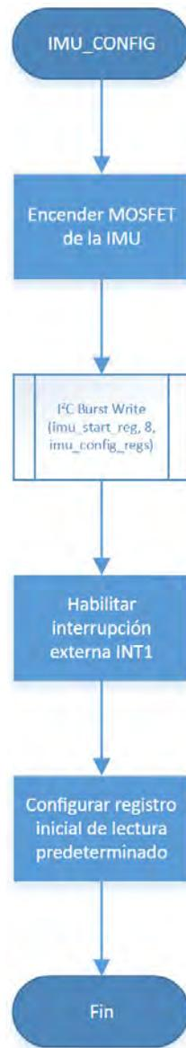
Figura 3.93: Diagrama de flujo de configuración de la IMU.
