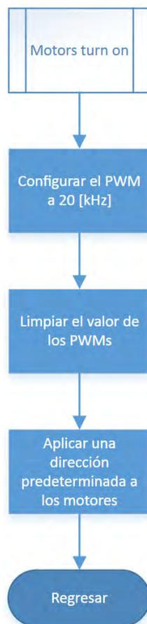
Figura 3.102: Diagrama de flujo de configuración del PWM.
