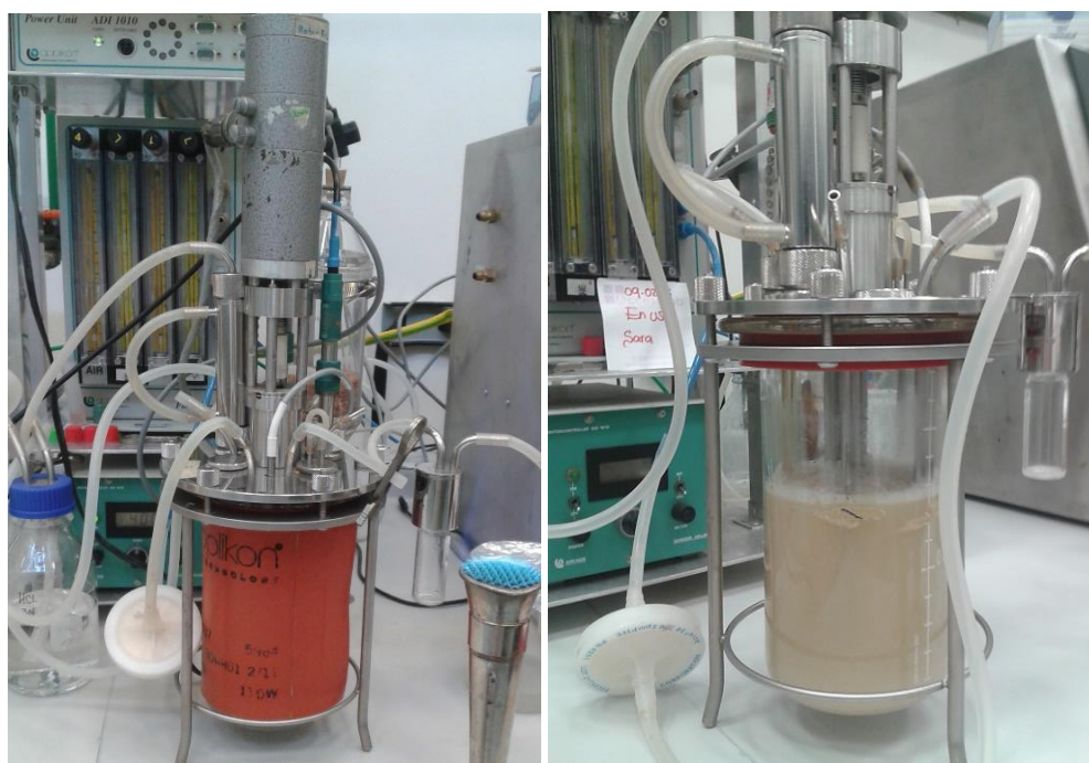
Figura 11. Biorreactor de 1.2 L conectado al sistema biocontrolador ADI 1010 ( Applikon, Netherlands ).
