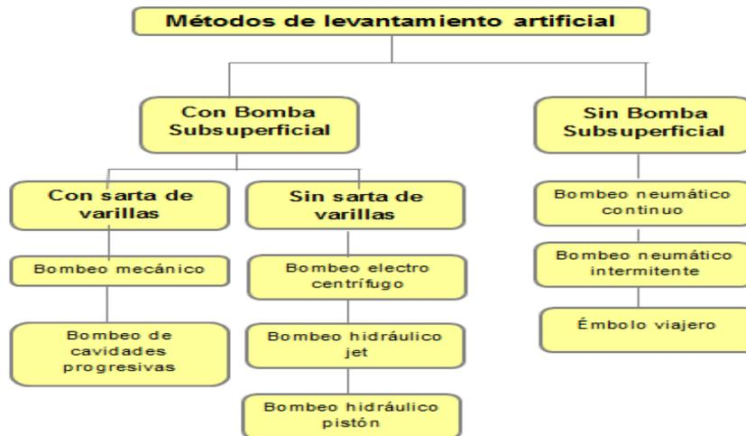
**Figura 1.1** Clasificación de los sistemas artificiales de producción <sup>[5]</sup>.
