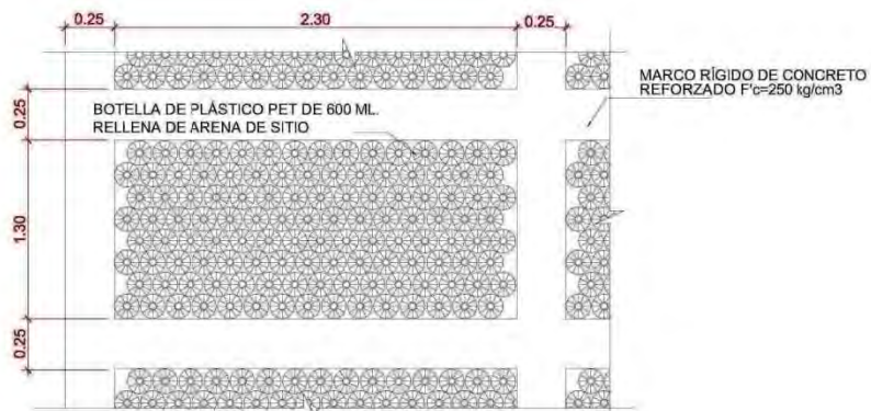
DETALLE MURO DE CARGA (VISTA FRONTAL)
