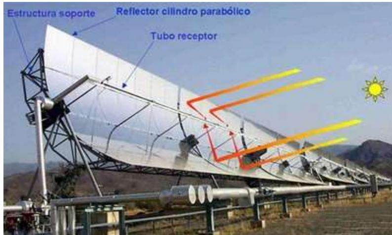
Fig. 2.11 Captador cilindro-parabólico.
