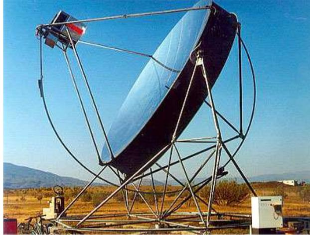
**Fig. 2.14** Colector Solar de Disco Parabólico. *Fuente: Plataforma Solar en Almería*
