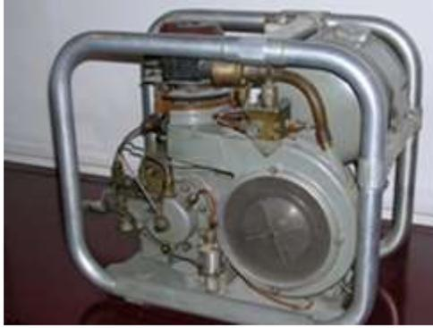
**Fig. 2.2** Motor desarrollado por Philips. Fuente: <http://www.stirlinginternational.org/>.
