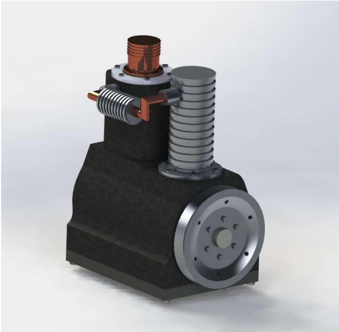
**Fig. 5.7** Diseño motor Stirling. *Fuente. Diseño propio SolidWorks*
