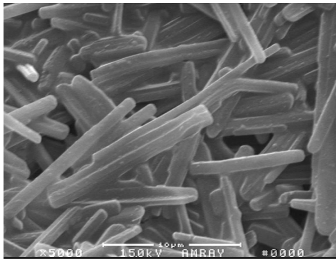
Figura 2.4.7: Microestructuras de la película radiocrómica EBT.[23]
