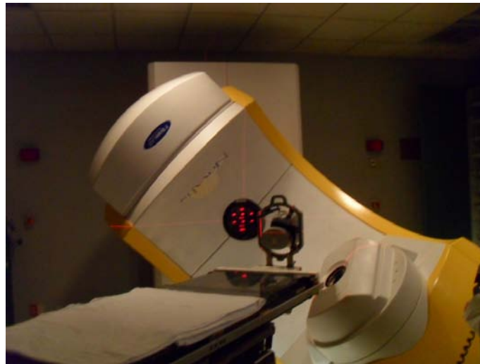
(c) Arreglo experimental del maniquí siendo irradiado en el acelerador lineal.
