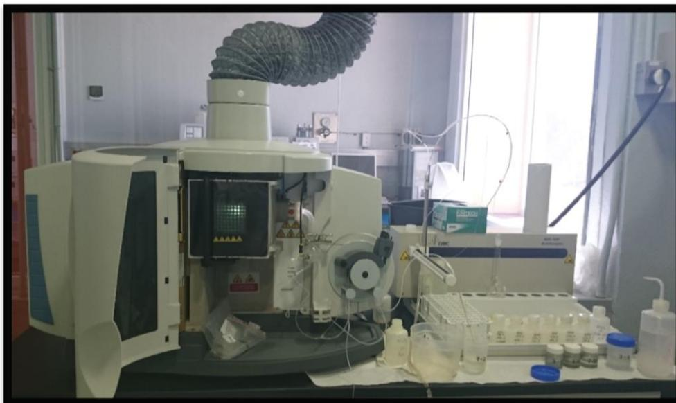
Figura 4.8. Equipo ICP-OES Thermo Scientific iCap 6000 utilizado para el análisis de muestras de cationes de agua.
