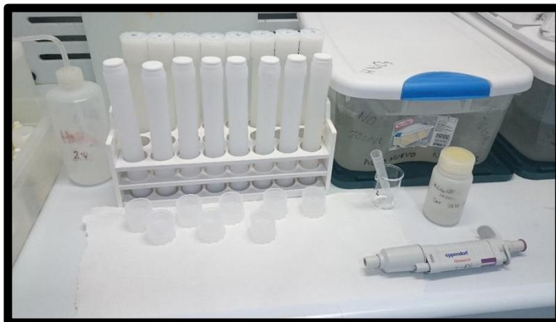
Figura 4.10 Adición de HNO<sub>3</sub> a las muestras de suelo para el método de digestión por el método EPA3651a
