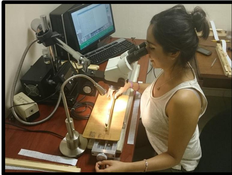
Figura 4.15 Equipo Velmex utilizado para la medición de anillos totales de las seis muestras
