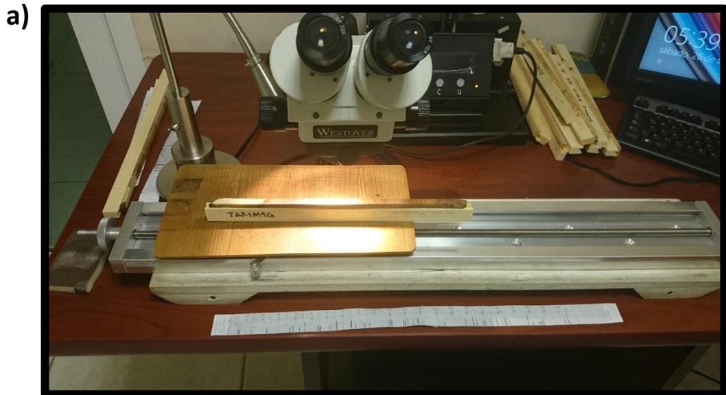
Figura 4.13 Prefechado de muestra en microscopio y elaboración de un gráfico de esqueleto por cada muestra
