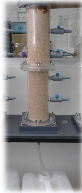
Figura 15. Columna empacada con la roca caliza después de transcurridos 6 días del proceso de remoción.
