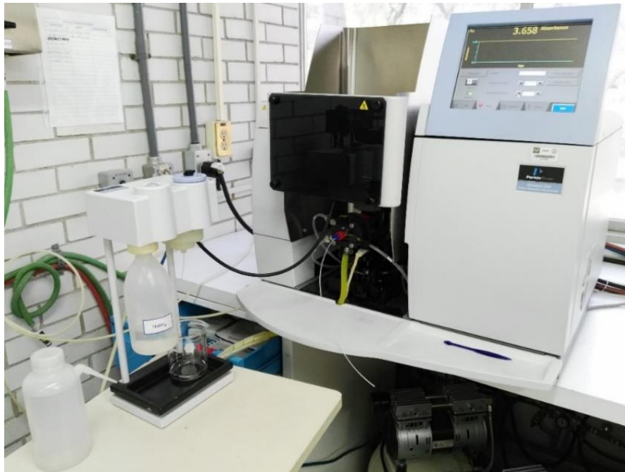
Figura 23. Equipo de absorción atómica Perkin Elmer AAnalyst 100 con generador de hidruros HGA 850, para la medición de As.
