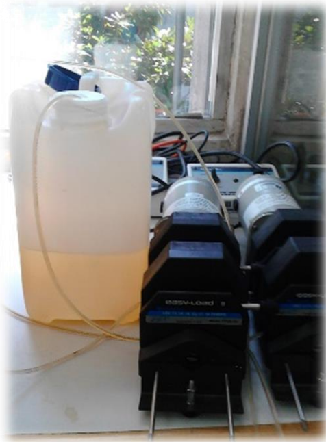
Figura 14. Sistema de bombeo mecánico easy-load II masterflex, modelo 77200-50 y bidón de 5 L de capacidad, después de 6 días de flujo del lixiviado a la columna.
