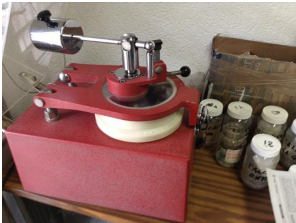
Figura 17 Mortero de Agata empleado para la molienda.
