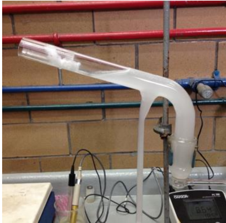
Figura 23 Tubo Hallimond utilizado en el experimento.
