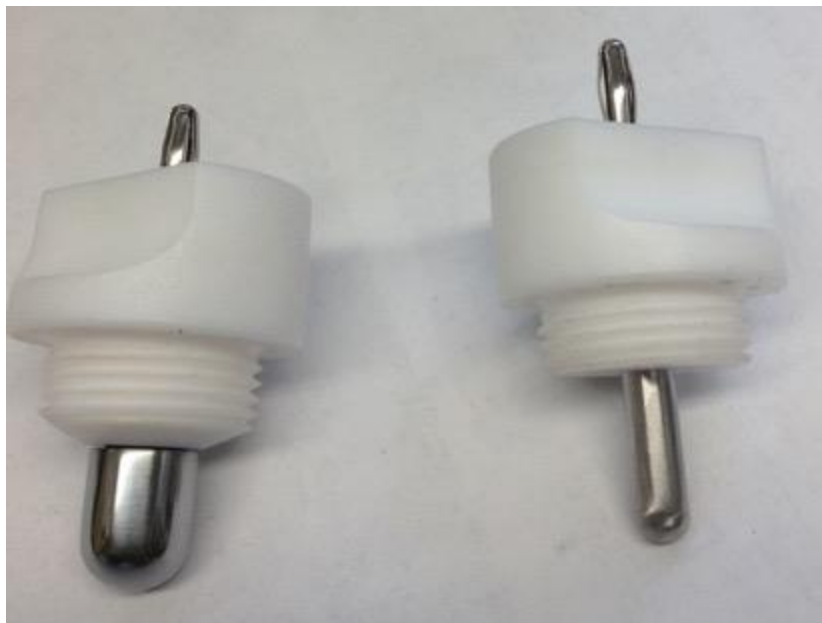
Figura 22 Electrodos de Molibdeno y Platino (izquierda y derecha respectivamente).
