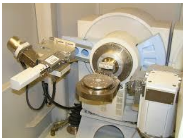
Figura 18 Equipo PANalytical para difracción de rayos X.
