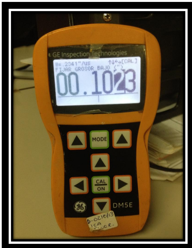
Imagen 23- DM5E calibración por dos puntos grosor bajo.
