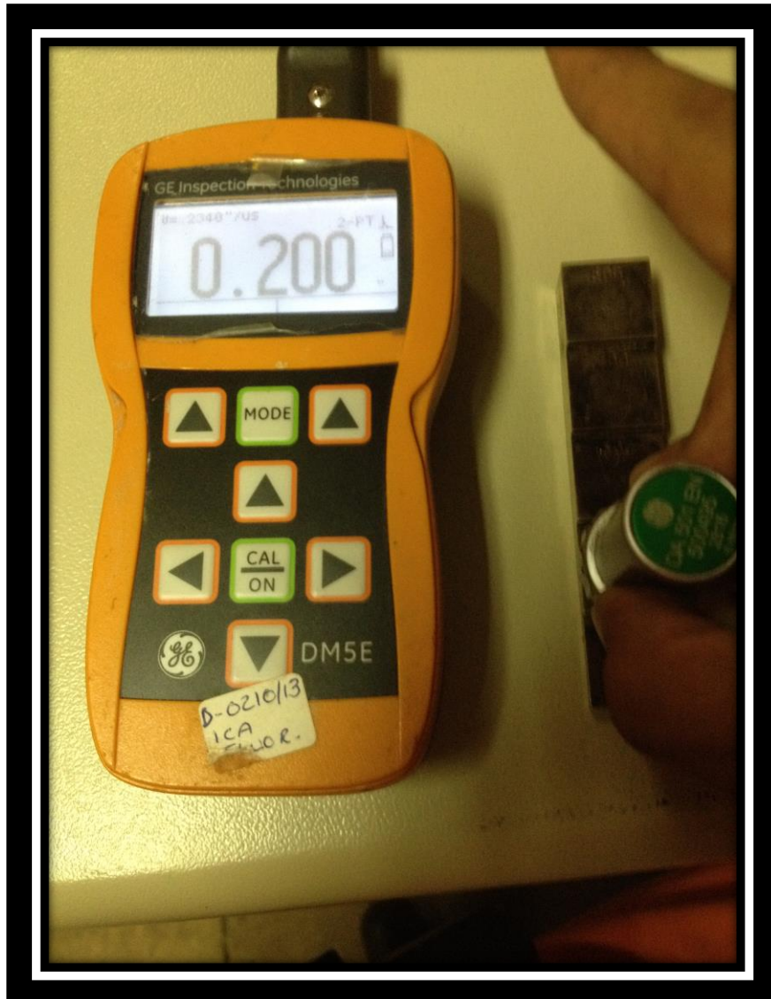
Imagen 21.- Medición de espesores en block de calibración.
