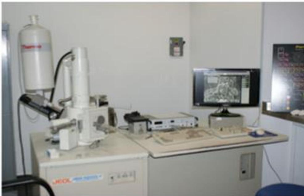
Figura 4.- Microscopio electrónico de barrido.
