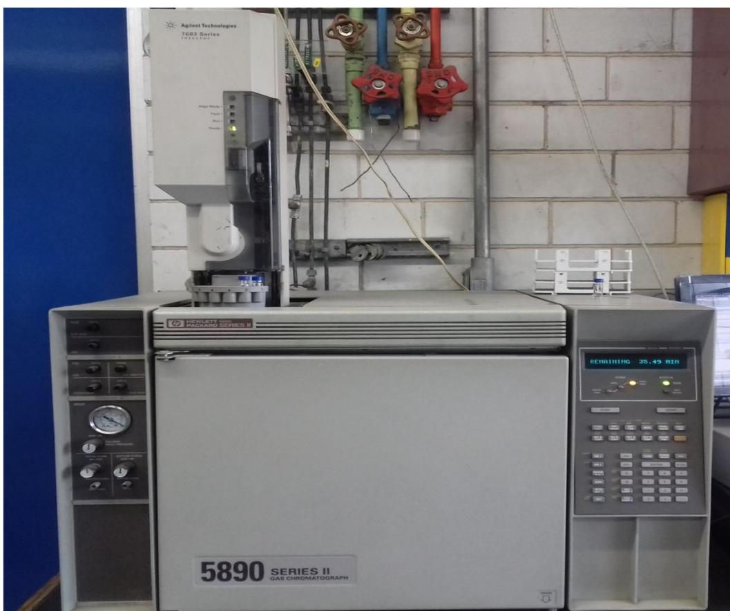
Figura 5.- Cromatógrafo de gases.
