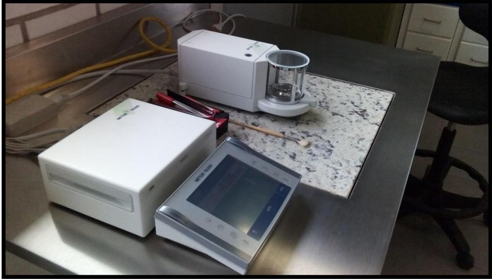
*Fig. 6.3 Microbalanza y panel de configuración*
