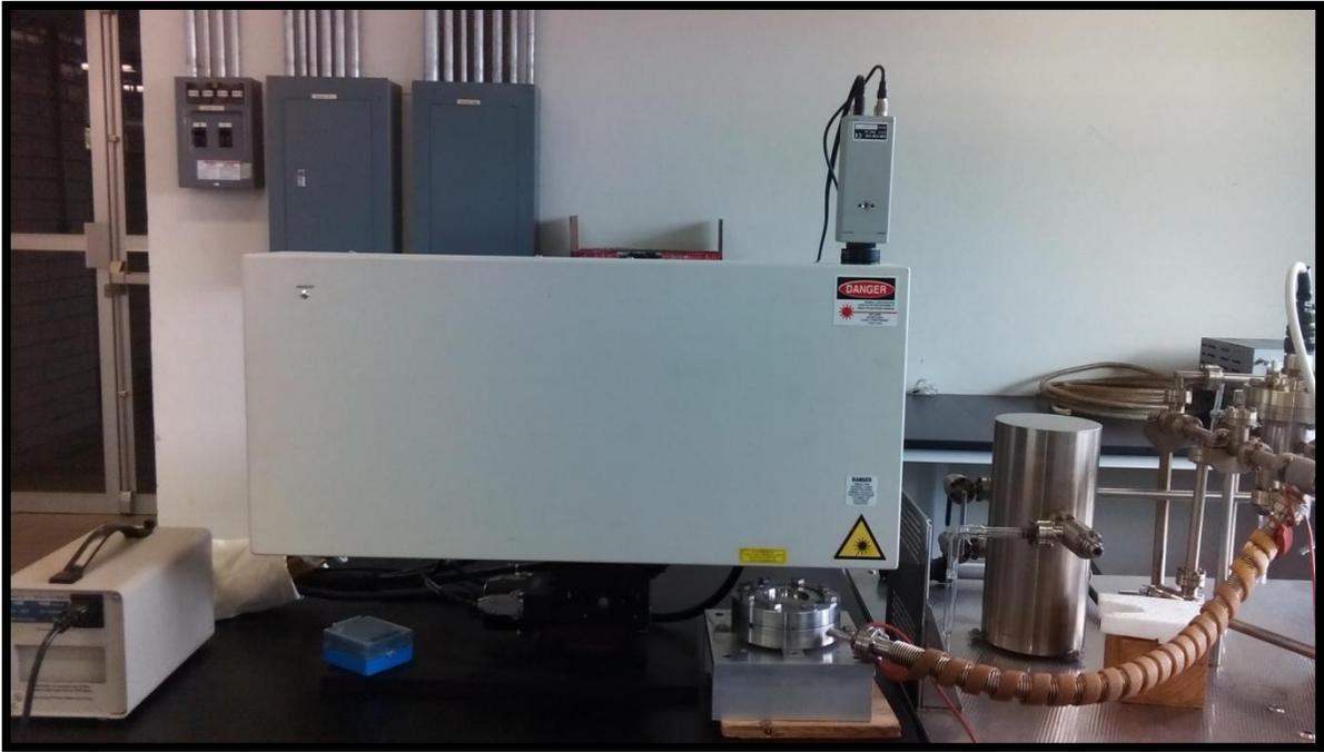
*Fig. 6.6 Laser infrarrojo de CO<sub>2</sub> acoplado al espectrómetro de masas*
