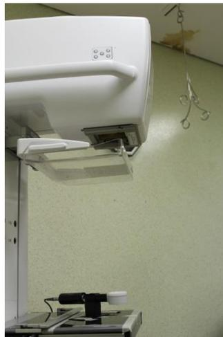
*Figura 3.8. Geometría para obtener el valor de la capa hemirreductora, misma que debe permanecer inamovible durante toda la prueba. Observe las placas de Al-1145 sobre el compresor. En el caso de los DR debe proteger al detector con una placa de plomo.*
