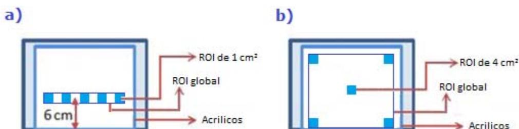
Figura 4. a) Posiciones de las ROI para la prueba de homogeneidad en equipos CR, b) Posiciones de las ROI para la prueba de homogeneidad en equipos CR.
