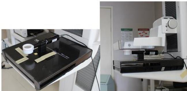
*Figura 8. Colocación de la cámara de ionización para la medida de rendimiento. En el caso de los DR debe proteger al detector con una placa de plomo.*
