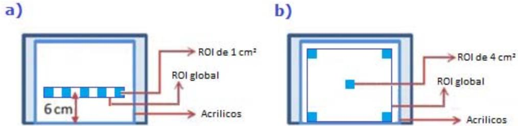
Figura 3.4. a) posiciones de las ROI para la prueba de homogeneidad en equipos CR, b) posiciones de las ROI para la prueba de homogeneidad en equipos DR.
