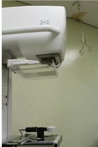
*Figura 9. Geometría para obtener el valor de la capa hemirreductora, misma que debe permanecer inamovible durante toda la prueba. Observe las placas de Al-1145 sobre el compresor. En el caso de los DR debe proteger al detector con una placa de plomo*
