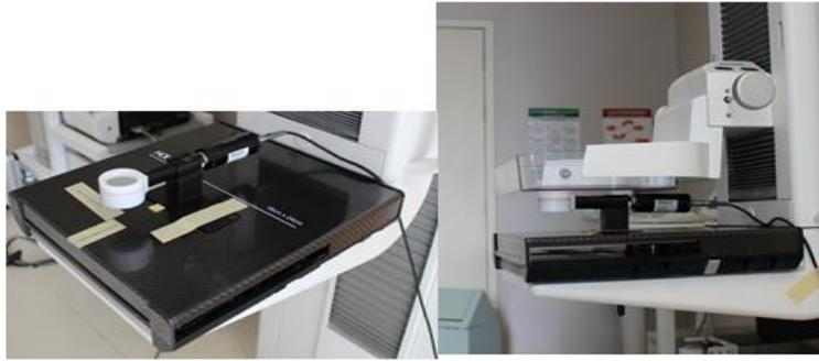
Figura 3.7. Colocación de la cámara de ionización para la medida de rendimiento. En el caso de los DR debe proteger al detector con una placa de plomo.
