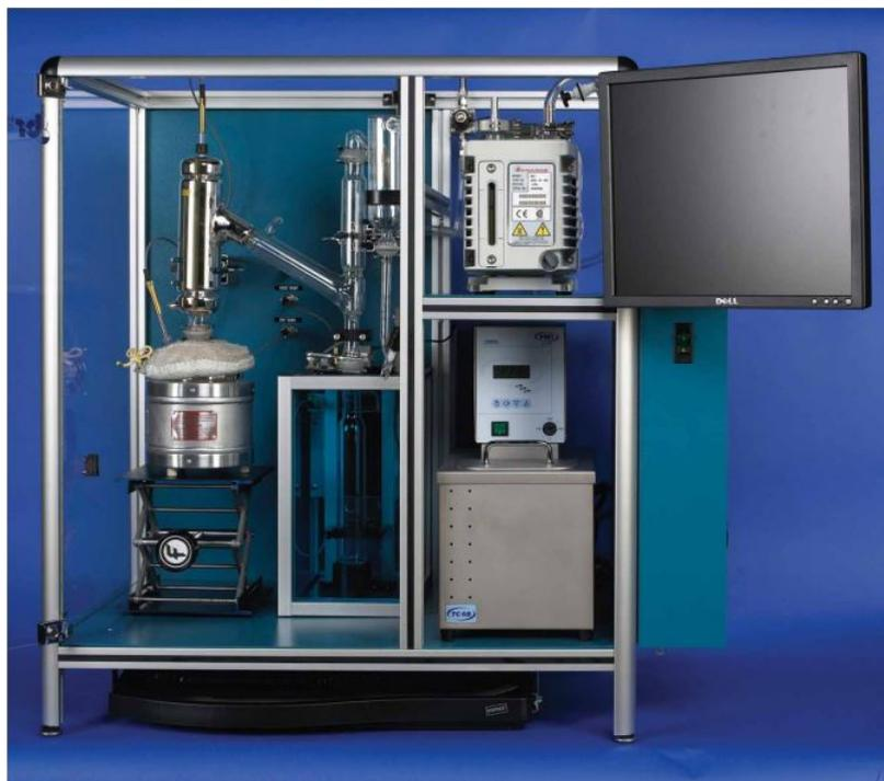
Figura 5.6: Instrumento B/R 1100 DC Scientific, Inc para el método ASTM D-1160.
