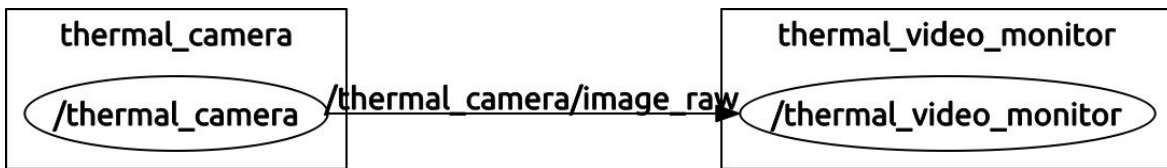
Figura 5.4 Imágenes de muestra de la cámara térmica a través de los módulos del sistema de detección de víctimas. El diagrama corresponde a los nodos en ejecución conectados por el canal de comunicación.
