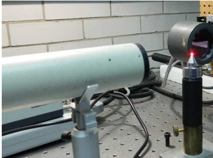
Figura 3.14. Láser incidiendo sobre un vástago de alineación.
