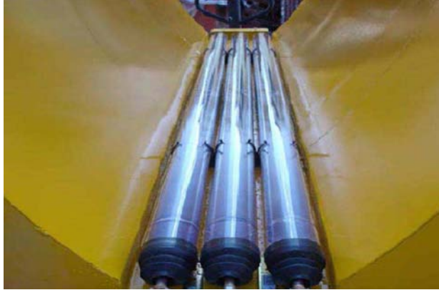
Figura 1.9. Concentrador Solar Compuesto, empleado para calentar agua. (Echeverría, 2011).
