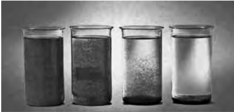
Figura 2.5 Disminución de la altura del espejo de lodos (Tomado de Trasisa,2016).
