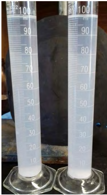
Figura 3.7 Comportamiento típico de las pruebas de sedimentación después de 2 horas.
