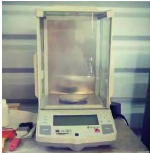
Figura 2.3 Balanza analítica Ohaus, Explorer con una capacidad de 210 g y una precisión de 0.1 mg.
