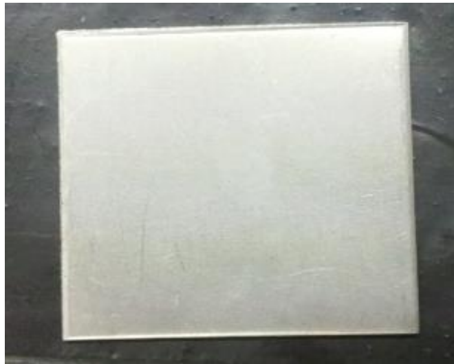
Figura 3.1 Probeta de llegada de acero inoxidable 316L utilizada para la evaluación de los tratamientos químicos de conversión.
