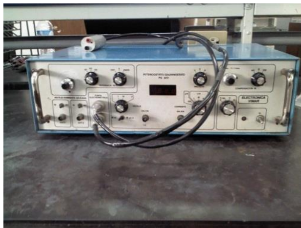
Figura 3.3 Potenciostato-galvanostato Vimar utilizado para la realización de distintas pruebas electroquímicas como lo fueron potencial contra tiempo y resistencia a la polarización.
