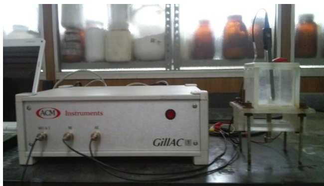
Figura 3.2 Celda utilizada para la realización de las pruebas electroquímicas, conectada al potencióstato GILL, con el electrodo de trabajo, de referencia y contraelectrodo.
