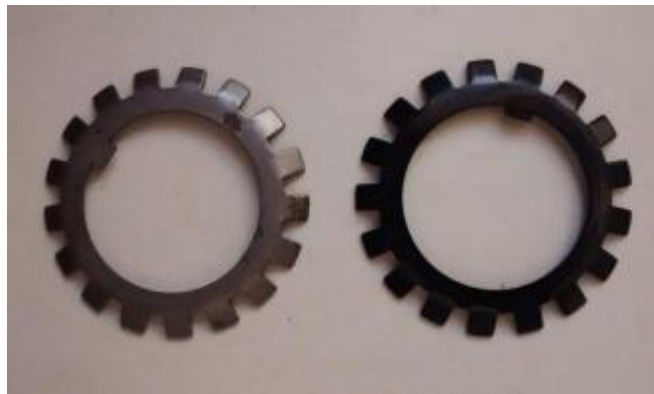
Figura 1.5 Ejemplo de una pieza antes del pavonado y después del pavonado por el método de inmersión o solución alcalina (6)
