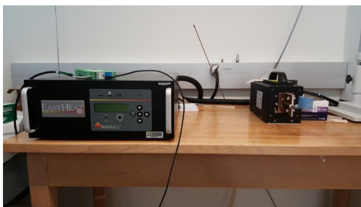
Figura 4.4: Equipo Easy Heat utilizado para realizar las pruebas, la bobina en la que se introdujeron las soluciones.
