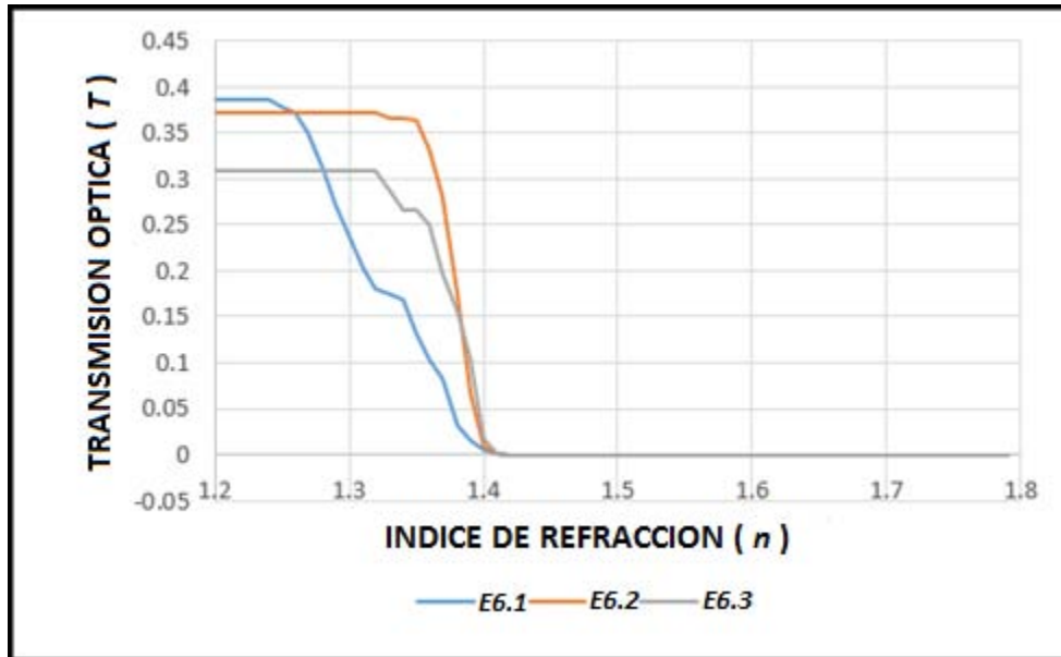
Figura 9.27. TRANSMISION OPTICA T Vs. INDICE DE REFRACCION n PARA TRANSDUCTOR E6
