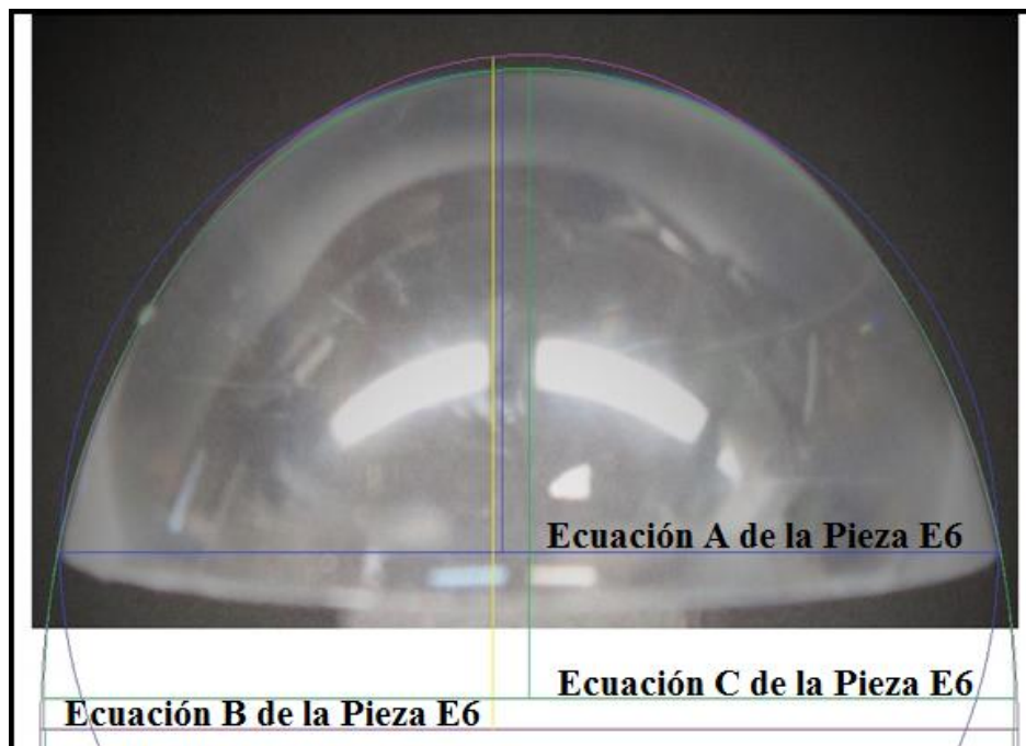
Figura 9.22. VARIANTES DE APROXIMACION DE SUPERFICIE CON TRES ELIPSOIDES DIFERENTES DE LA PIEZA E6
