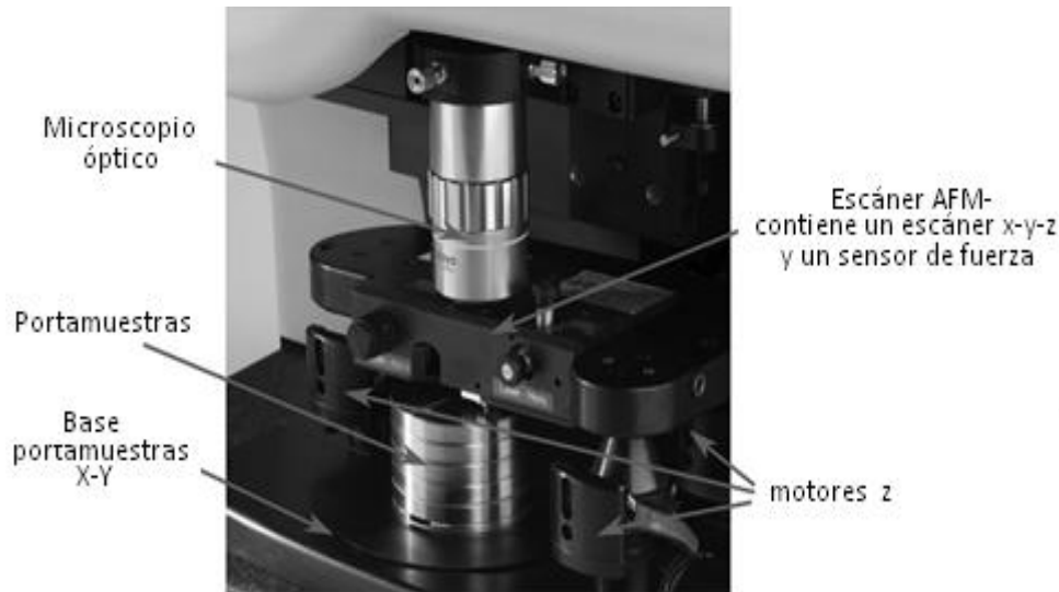
Fig. 2.11 Componentes principales de un microscopio de AFM
