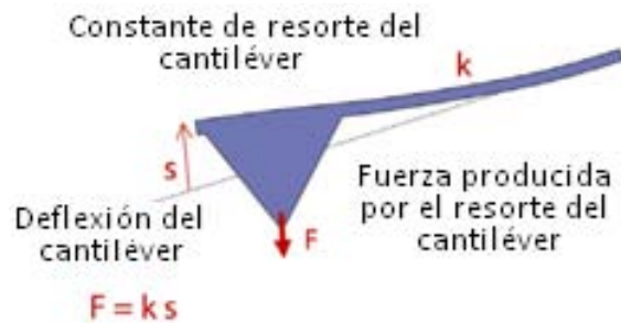
Fig. 2.10 Esquema representativo del principio físico de la sonda.
