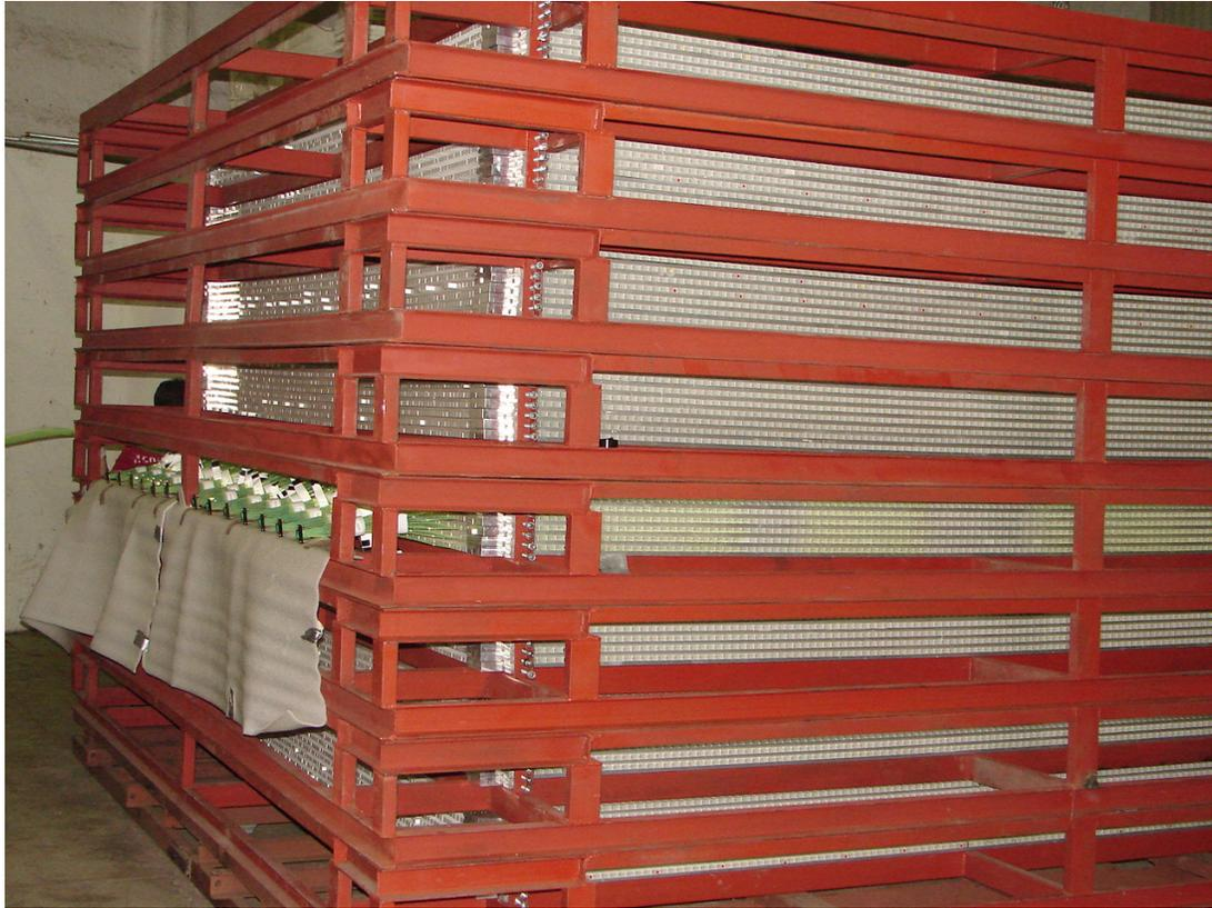
Figura 6.1: Foto del SciCRT, en ella observamos el arreglo de las barras de centelleo, distribuidas en los 8 bloques apilados uno encima del otro, cada bloque contiene 8 capas de plástico centellador (con un espesor de 20 *cm*).
