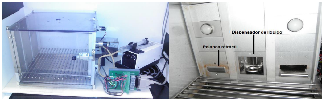
Figura 18: Prueba de Condicionamiento operante: equipo utilizado para evaluar aprendizaje de tipo asociativo en las crías macho de la rata.
