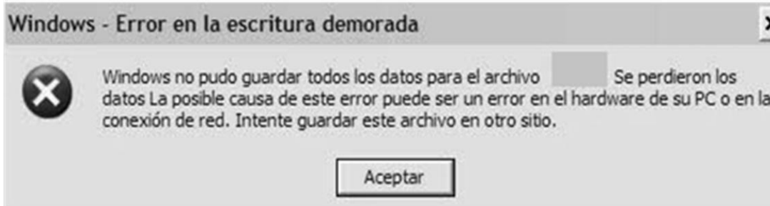
Figura 47. Visualización del mensaje de error para una demora en los procesos de escritura de datos.
