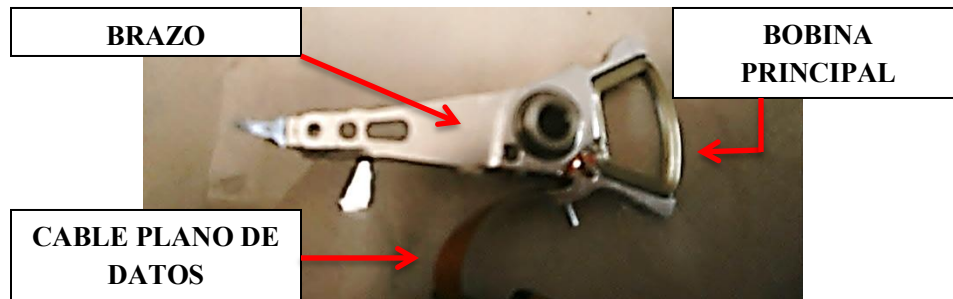
Figura 14. Brazo, cable plano de datos y bobina principal para un DDE.
