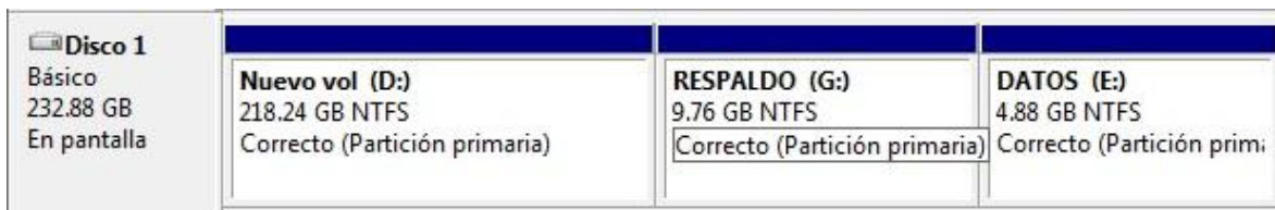
Figura 33. Visualización del volumen lógico a través del software “ diskmgmt.msc ” para una restauración exitosa por daño consistente en la tabla de particiones.
