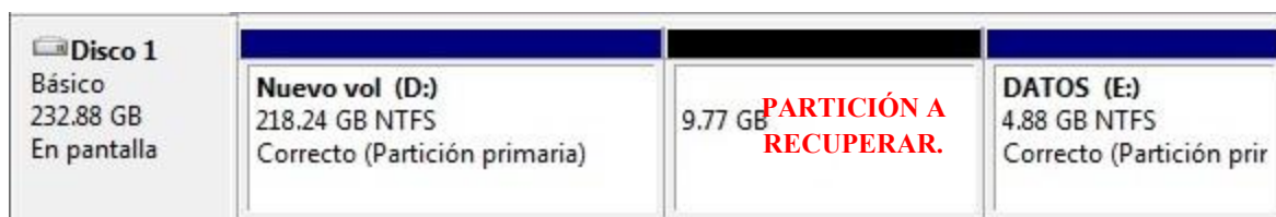
Figura 31. Visualización del volumen lógico a través del software “ diskmgmt.msc ” para un daño consistente en la tabla de particiones.
