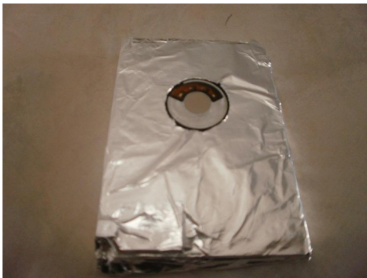
Figura 41. Recubrimiento del DDE con papel tipo aluminio y exposición del área que contiene al motor.
