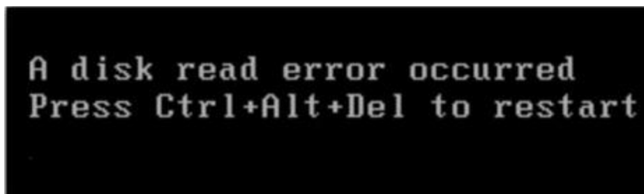
Figura 23. Visualización de mensajes de error para fallas en la firma “0XAA55” del sector RAP (1).
