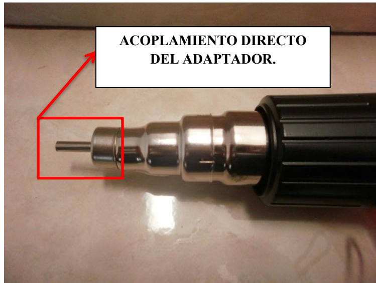
Figura 43. Instalación del adaptador y aseguramiento físico del mismo en contra de la pistola de aire caliente.
