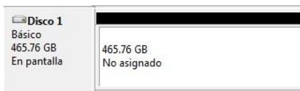
Figura 25. Visualización del DDE a través del software “ diskmgmt.msc ” por corrupción en el sector RAP.
