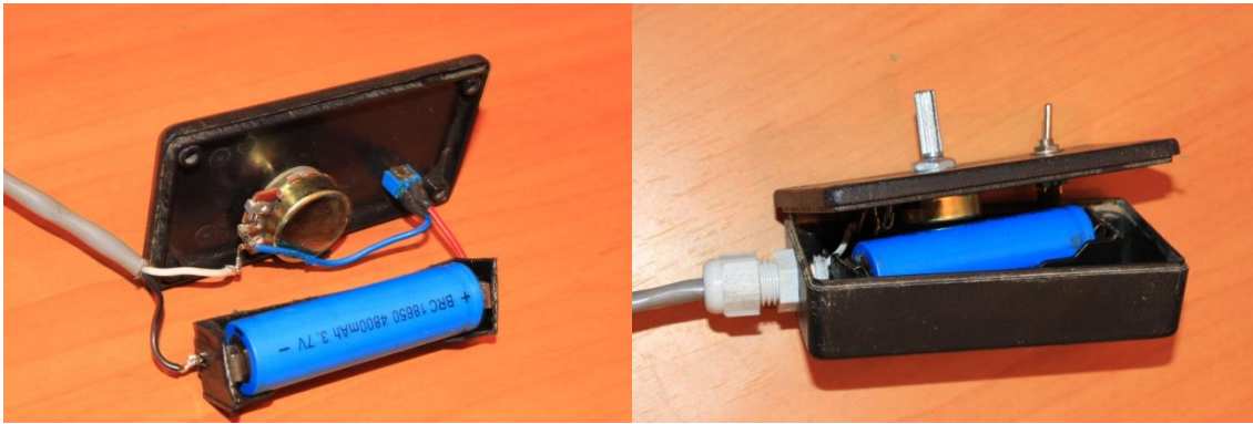
Figura A.2. Caja de control del dispositivo experimental. En las imágenes pueden apreciarse la batería Li-ion, el interruptor y el potenciómetro colocados dentro de una caja para componentes electrónicos.
