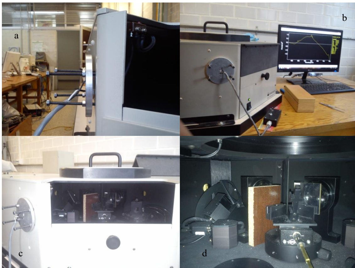
Figura A.6. a) Vista lateral del dispositivo montado en la ventana auxiliar del EF. b) Dispositivo colocado en su posición. c) y d) Puede apreciar se que la luz procedente del LED incide en el centro del detector del EF.
