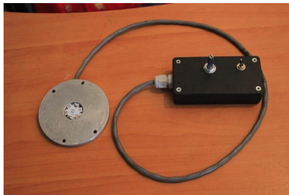
Figura A.3. Dispositivo experimental. En la foto aparece la caja de control y el LED UV montado justo al centro de la pieza circular de aluminio que se fabricó.
