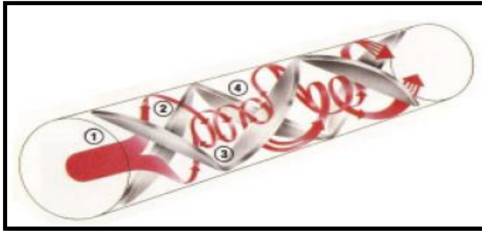
Figura 8.6.- Principio de operación de un mezclador estático
