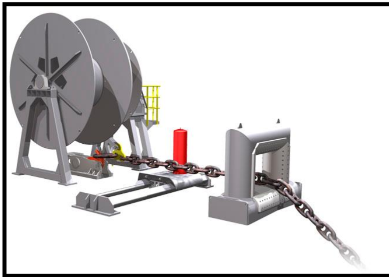
Figura 9.1.- Esquema del sistema de amarre en tándem
