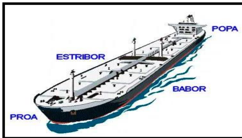
Figura 1.2.- Esquema de las partes externas de un buque (García Roberto 2012)
