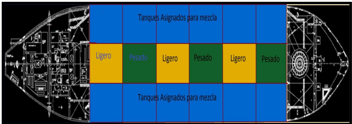
Figura 7.2.- Disposición de tanques de almacenamiento de un ejemplo típico de un FPSO (PEMEX 2005)
