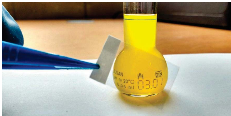
Fig. 1.7. ITO comercial de algunos nanómetros de grosor depositado sobre una película micrométrica de tereftalato de polietileno (PET).
